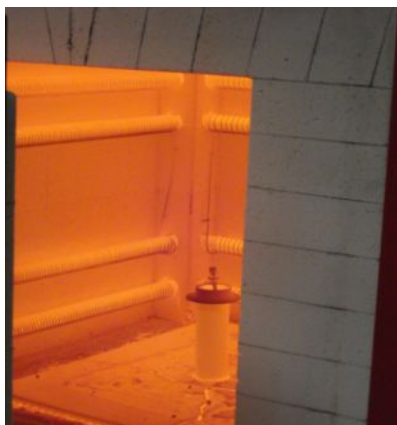
Obr. 4: Vysokoteplotní pec při teplotě 950 °C.
